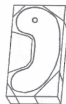
の部分を砥石で削り、だいたいの形を作る。
