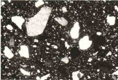
3. 八代玉作遺跡・629(安行式・製塩土器) パーサイト構造のカリ長石(左上)と石英粒 +ニコル (20)倍
