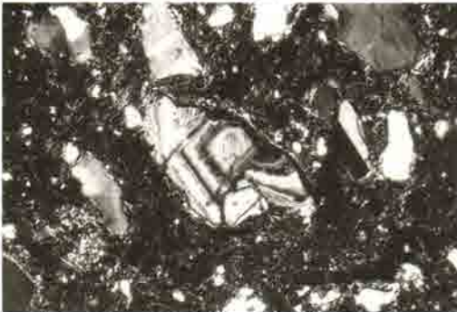
3. 多古田遺跡 533(安行3 a式・粗製土器) 累層構造の斜長石(中央) +ニコル (20)倍
