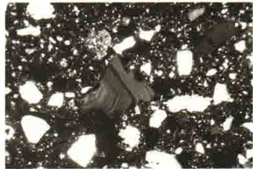
8. 飯合作遺跡 402(安行3a式) 累帯構造の斜長石(中 央) +ニコル (20)倍
