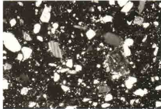
4. 姥山貝塚 516(荒海式・精製土器) 砂岩を多量に含む組成 +ニコール (20)倍
