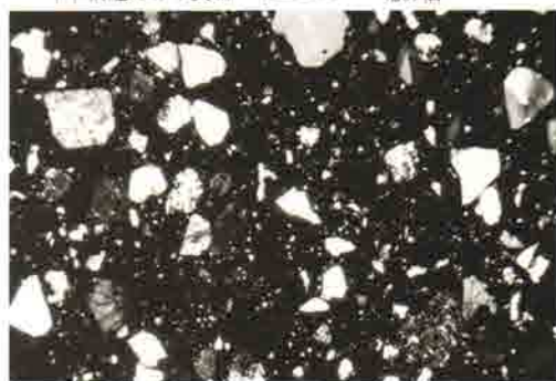
6. 神門4号墳 187(五領式以前) 多種類の粒径をもつ砂粒 +ニコール (20)倍
