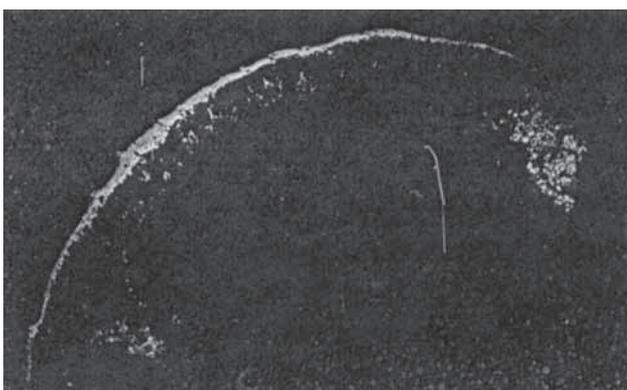
写真15 酸化膜片のマクロ組織（鍛造剥片と鉄滓表層皮） ×20
