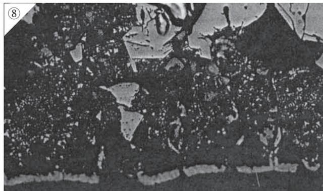
写真13 酸化膜片の顕微鏡組織 (3)
