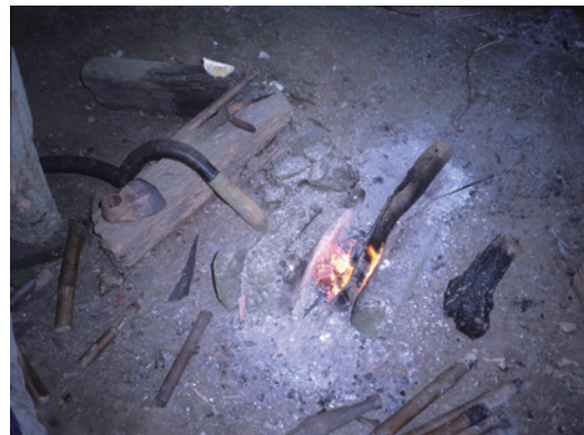
2 薪の燃焼によるナタ成形段階の鍛冶
