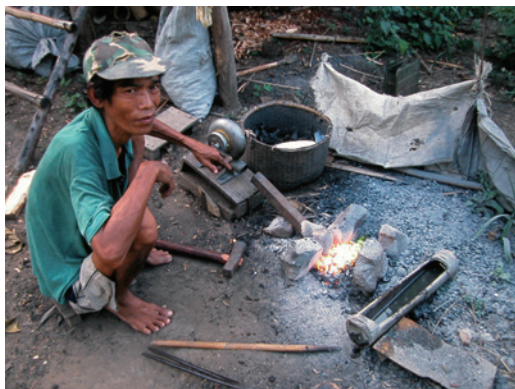
1 炉壁として並べた礫の間から送風する構造の鍛冶炉
