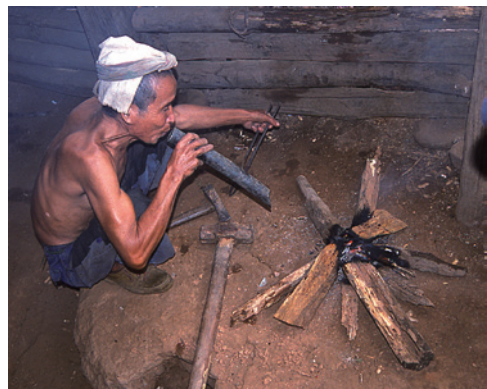
3 薪と吹き筒による加熱で小鉄片に刃を付ける
