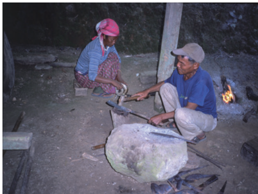
2 薪の燃焼によるナタ成形段階の鍛冶
